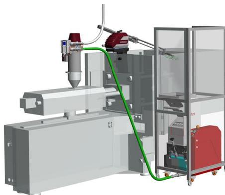
***Darstellung einer Inline-Recycling-Zelle mit Angusspicker, Mühle und Fördergerät***
